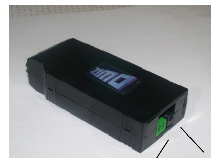
Anschluss Update-Gleis Betriebskontroll-LED's hinter der Buchse Buchse für Netzgerät
